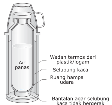
■ Gambar 4.6 Bagian-bagian Termos
